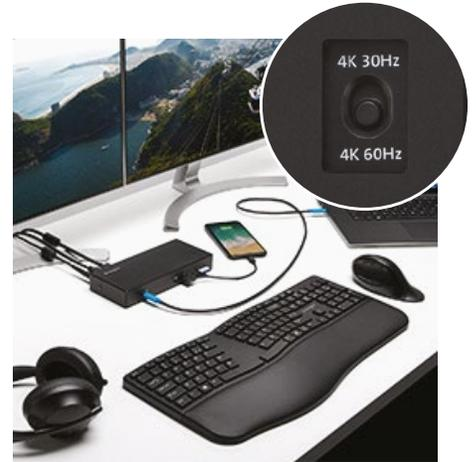
Conectividad USB-C sin controlador con velocidad de transferencia de datos de 10 Gbps y Entrega de energía de 100 W (PD 3.0) para todas los notebook con sistema operativo Windows con un puerto USB-C compatible con el modo Alt de DisplayPort y la entrega de energía
